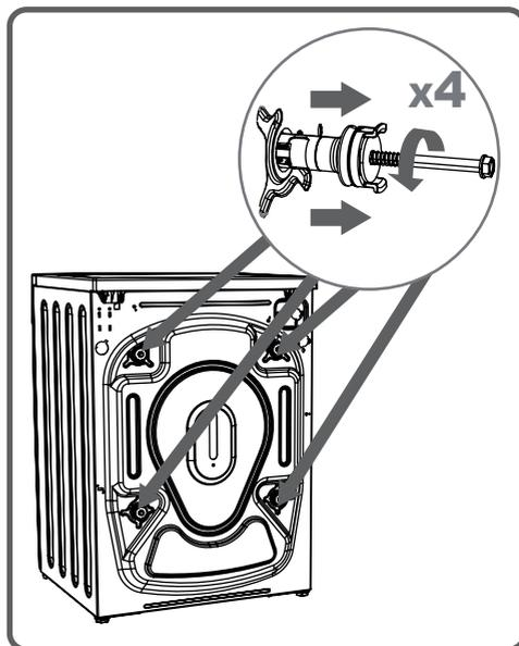
**ΣΗΜΕΙΩΣΗ:** Πρέπει οπωσδήποτε να αφαιρέσετε τις βίδες μεταφοράς της συσκευής πριν την πρώτη χρήση. Βλάβες που θα προκύψουν στη συσκευή αν λειτουργήσει με τοποθετημένες τις βίδες μεταφοράς, δεν θα καλύπτονται από την εγγύηση.
