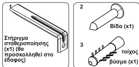
Η σακούλα εντύπων περιέχει ένα κιτ για τη σταθεροποίηση της συσκευής. Στερεώστε το στήριγμα σταθεροποίησης (1) στο έδαφος χρησιμοποιώντας τη βίδα (2) και το ούπατ (3) όπως φαίνεται στην παρακάτω εικόνα. Ρυθμίστε το ύψος του βραχίονα σταθεροποίησης έτσι ώστε να ευθυγραμμίζεται με την υποδοχή στην κουζίνα και σφίξτε τη βίδα. Σπρώξτε τη συσκευή προς το βραχίονα, βεβαιωθείτε ότι ο βραχίονας για την αποφυγή ανατροπής έχει εισαχθεί στην υποδοχή στο πίσω μέρος της συσκευής.
